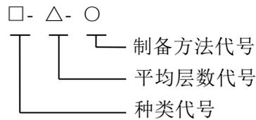
图1 石墨烯材料产品代号示意图
